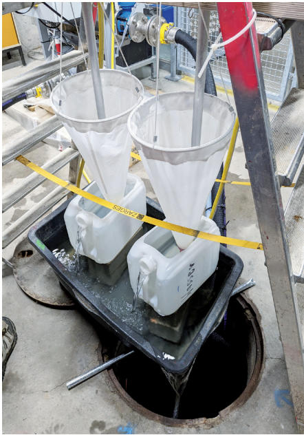
Bild 4. Probenahme mittels Veligersieben.
